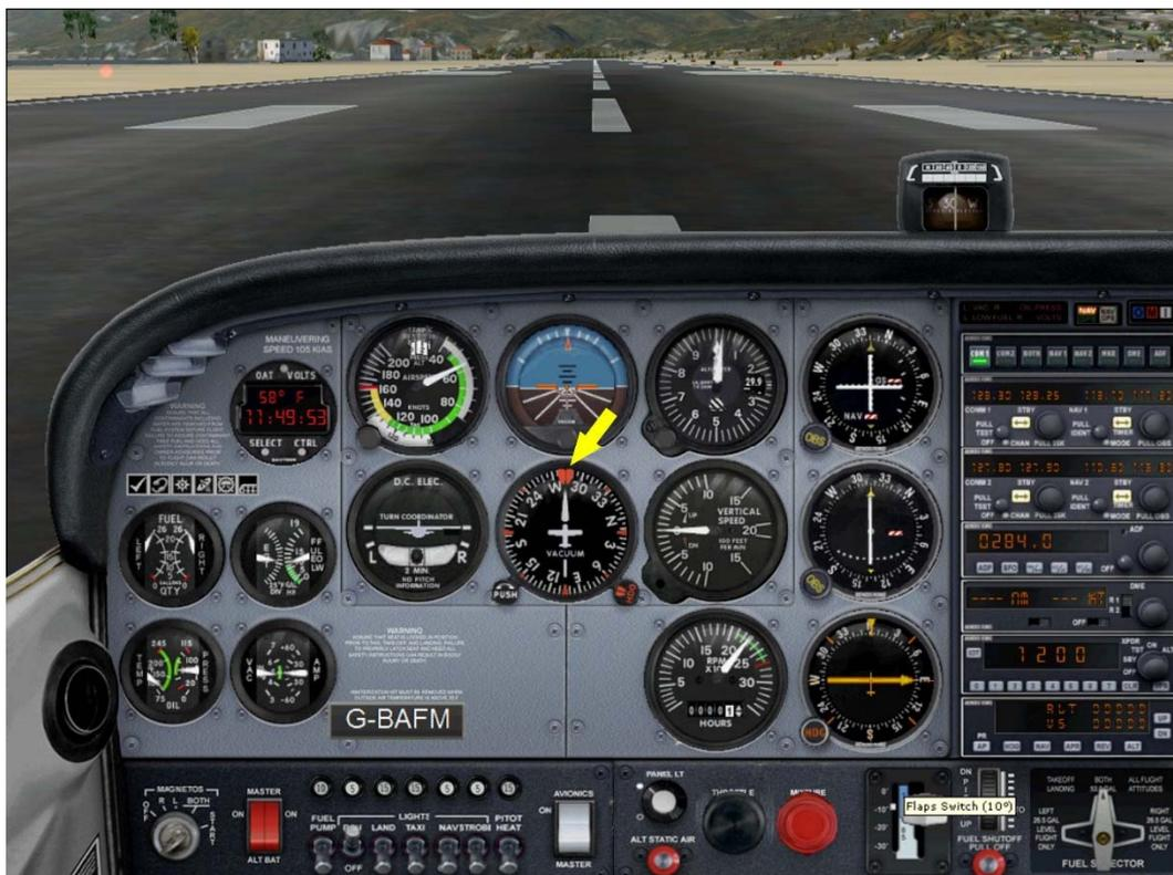
Ora mettiamo una tacca di flap e diamo tutto gas – con la pedaliera (e solo con quella) teniamo l'aereo dritto sino a raggiungere una velocità sufficiente (ago in arco verde) col C172 circa 70 kts.
