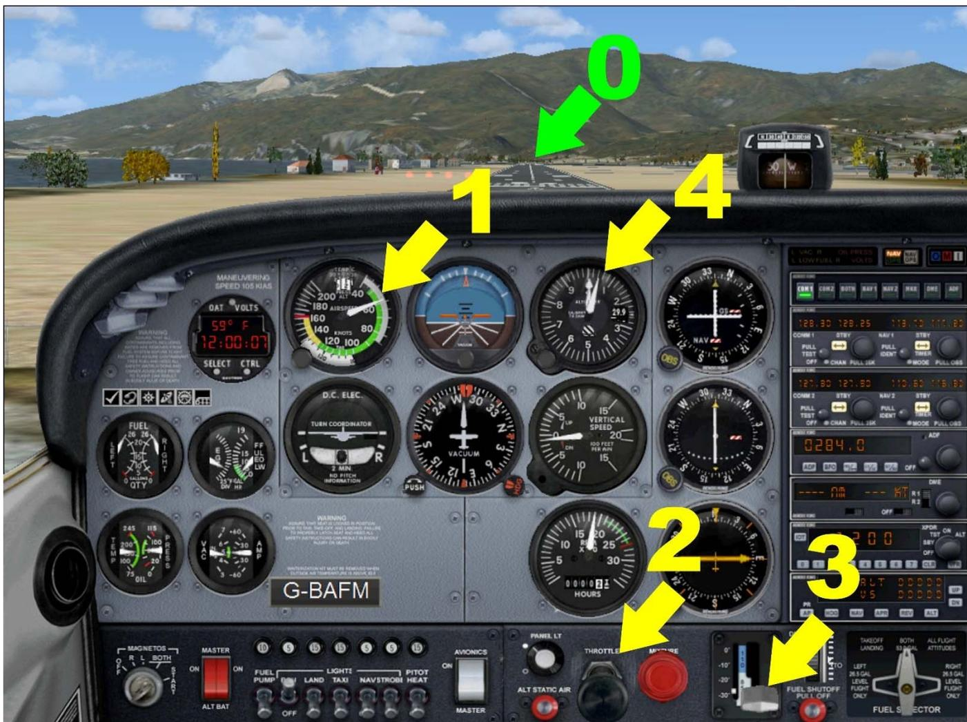
0. Il riferimento esterno che dobbiamo tenere è la testata pista opposta. Non possiamo guardare la testata sotto di noi, perché, appunto, è sotto. Ci allineiamo e teniamo come riferimento la FINE DELLA PISTA
